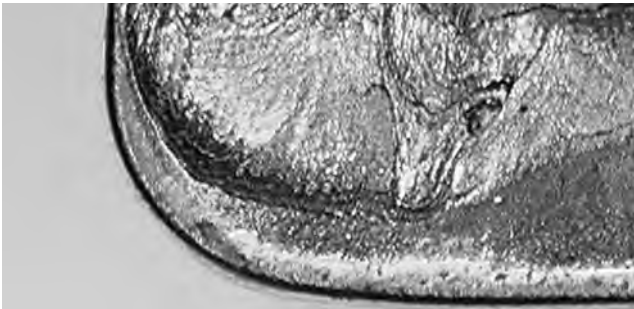
Отходящая горячая стружка вызывает образование лунки на передней поверхности режущей кромки.
